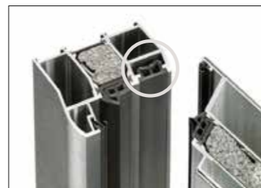
La scanalatura per il montaggio per nascondere le viti di fissaggio del telaio, copre le viti, per maggiore facilità di pulizia
